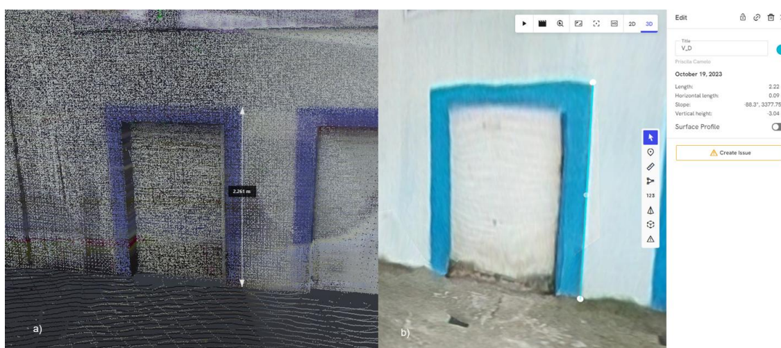
Figura 3. (a) Medida vertical extraída no Recap Pro, (b) Medida vertical extraída no DroneDeploy.
