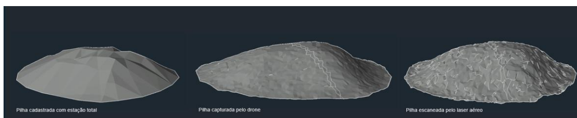
Figura 11. Comparação entre a triangulação das superfícies da pilha C obtidas por diferentes métodos.
