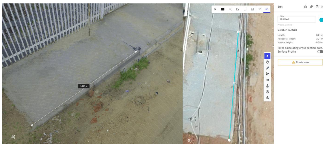
Figura 2. (a) Medida horizontal extraída no Recap Pro, (b) Medida horizontal extraída no DroneDeploy.
