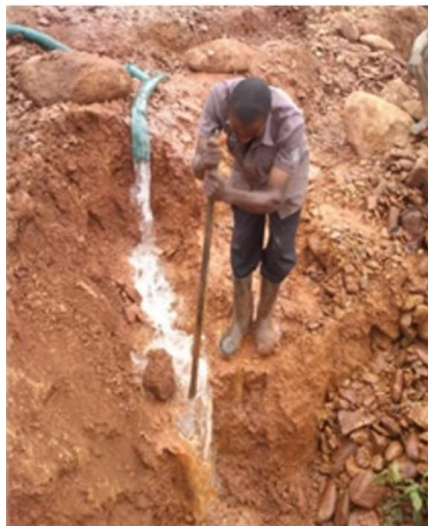
Figura 1. Técnica de desmoronamento de solos
