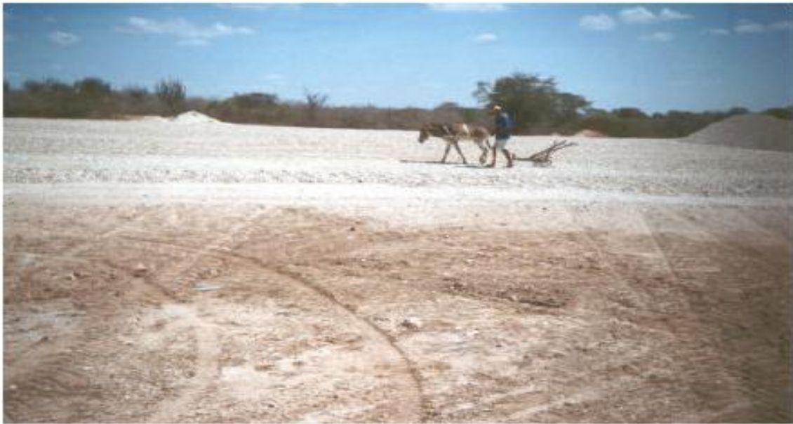
Figura 4. Secagem de bentonita ativada ao Sol na NERCON, utilizando o arado puxado a burro. Recriação das heranças técnicas da agricultura tradicional na mineração. Fonte: Farias (2003, p.138).
