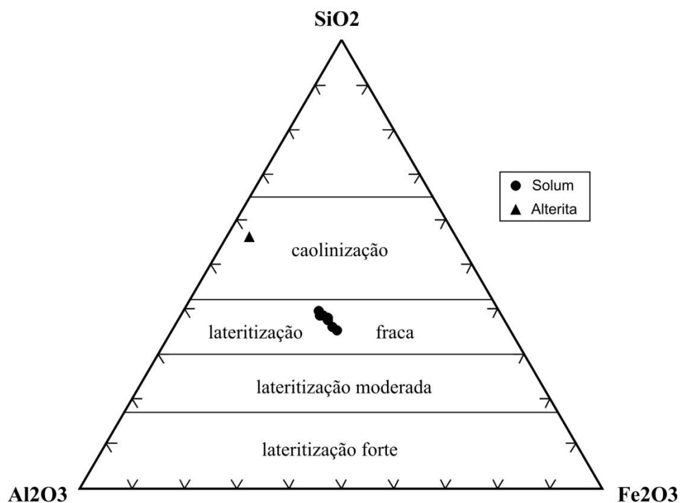
Figura 6: Diagrama da lateritização segundo Shellmann (1982), citado por Herbillon & Nahon (1985): as amostras do solum se inserem no domínio da lateritização fraca e a amostra da rocha pouco alterada, no domínio da caolinização.
