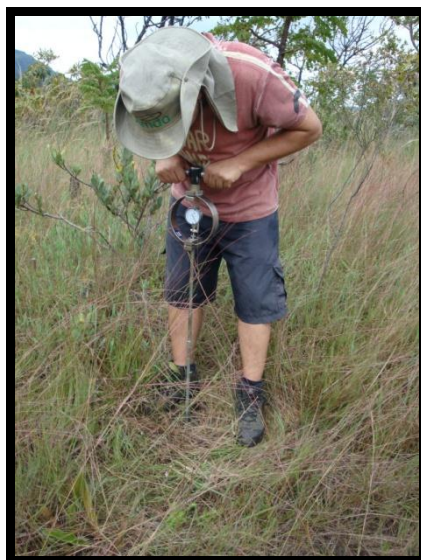
Figura 2 – Utilização do penetrômetro de cone com anel dinamométrico. R. C. Takeuchi (2009)
