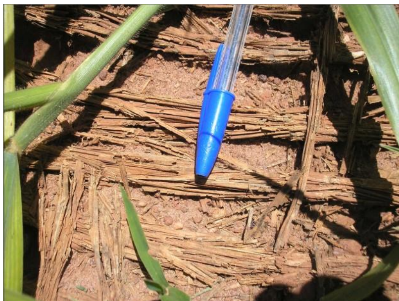
Figura 13. Processo de biodegradação do geotêxtil fornecendo matéria orgânica para o solo no penúltimo mês de monitoramento.
