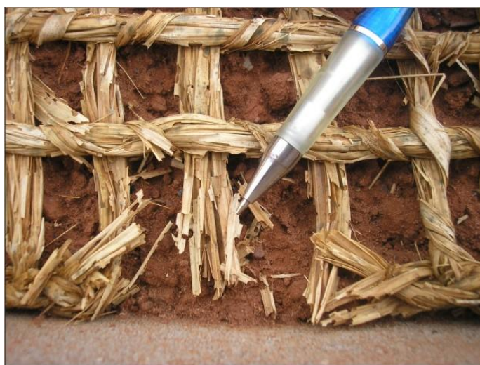
Figura 12. Vista parcial do processo de biodegradação do geotêxtil fornecendo matéria orgânica para o solo no início do monitoramento. Autoria: BEZERRA, J.F.R, 22.11.05.
