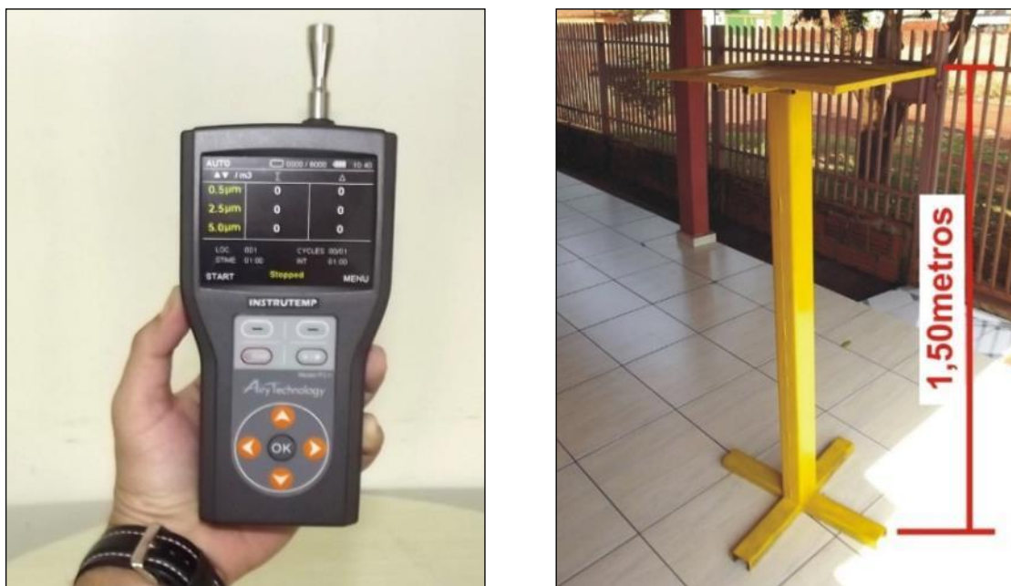
Figura 3 – Equipamento P311 e plataforma de apoio para amostragem. Fonte: SANTOS (2014, p. 100-101)
