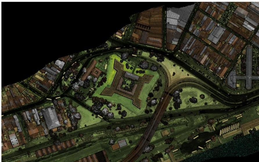
Figura 8 – Imagem colorida formada por nuvens de pontos LIDAR do Trecho do bairro de São José – Cais Estelita - Recife– Vista ortogonal – Destaque no Viaduto, armazéns, Forte das Cinco pontas e vegetação
